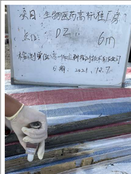
土壤 VOC 取样
