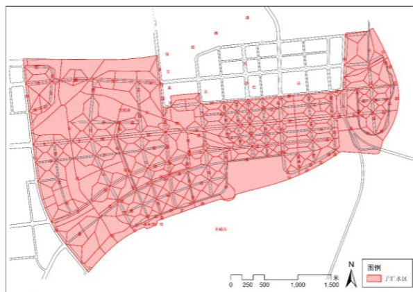
图 3 子汇水区划分图 Fig.3 Partition Map of Sub Catchment Area
