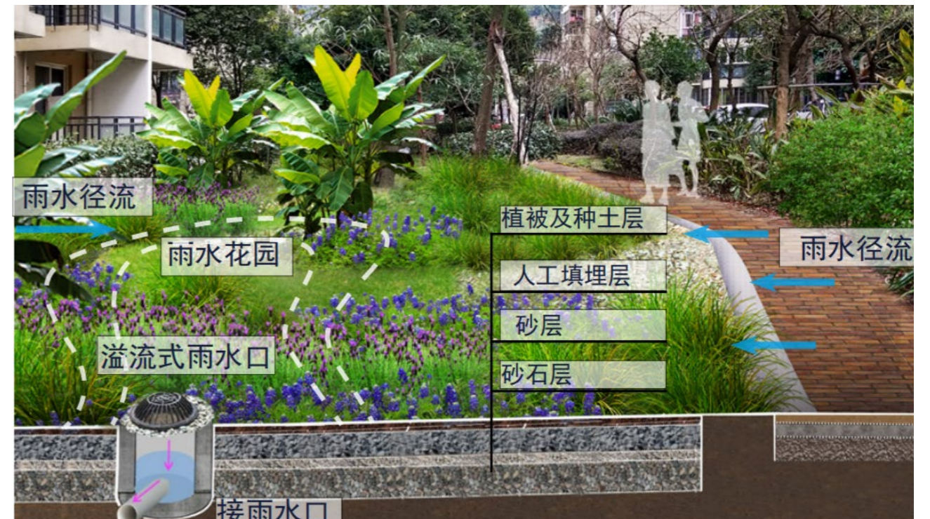
▲ 下凹式绿地构造及雨水径流组织示意
