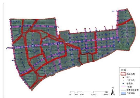
图10 一维 / 二维耦合内涝模型界面
